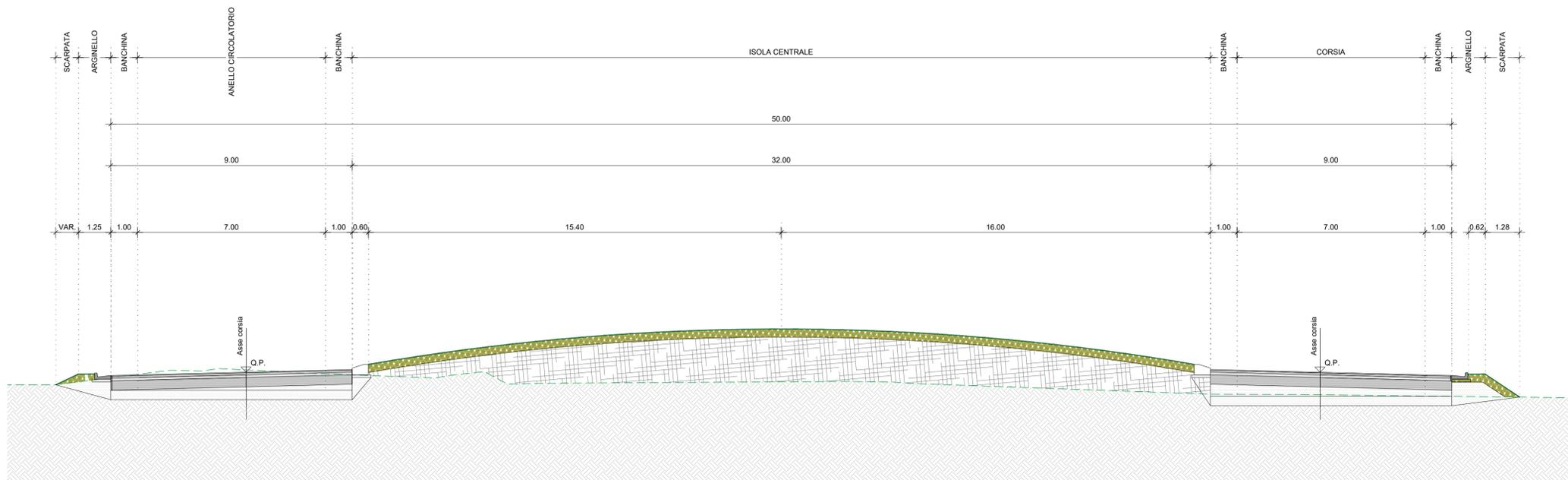
SEZIONE TIPOLOGICA ROTATORIA VIA DELL'AEROPORTO | SCALA 1:100
